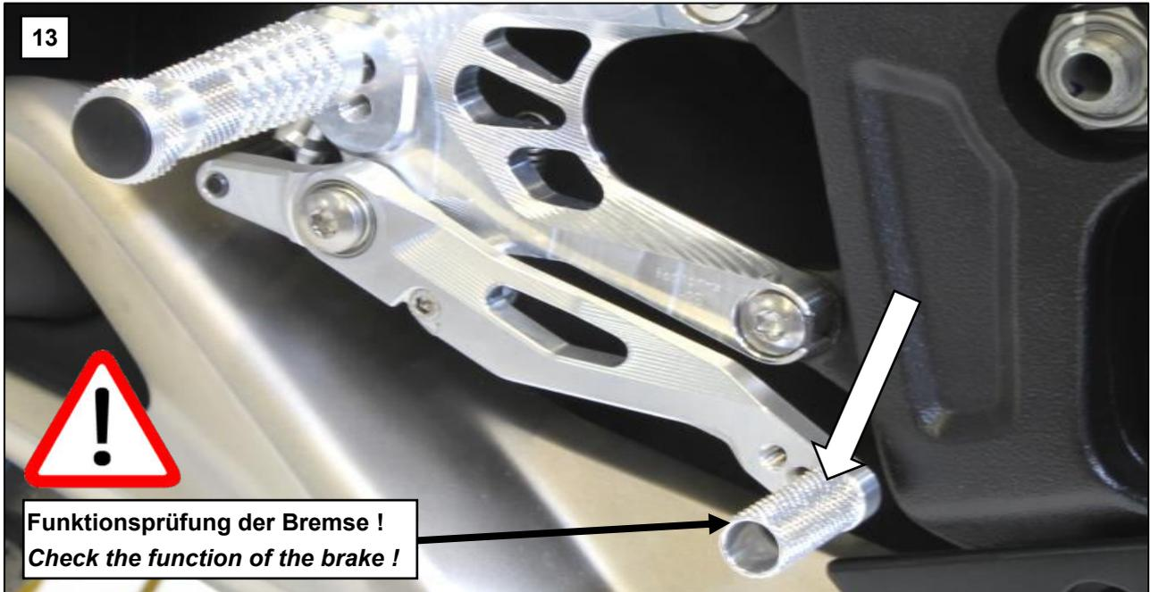
**Zur Durchführung des folgenden Tests sollte das Hinterrad frei drehbar in der Luft sein!**
