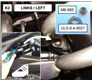
**K:** Installieren Sie den Bremsausgleichsbehälter mit den dargestellten Bauteilen.
