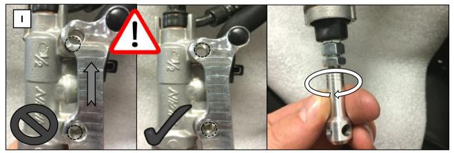
I: Prüfen Sie, ob die Bohrungen des Bremszylinders deckungsgleich mit den Bohrungen der Rastenanlage sind. Falls nicht, ziehen sie den Bremsenadapter **UAD03-30** vom Bremsbolzen **BR-07** und drehen diesen in entsprechende Richtung bis die Bohrungen in einer Flucht zueinander stehen. (anderfalls stimmt das Bremsenspiel nicht)!
