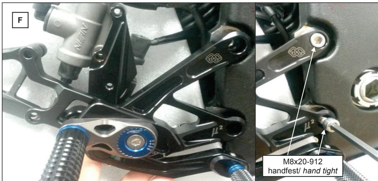
**F:** Setzen Sie die Rastenanlage an die beiden Anschraubpunkte des Rahmens und vor den Auspuffhalter. Die Rastenanlage wird mit den zwei Schrauben **M8x20-912** handfest fixiert.
