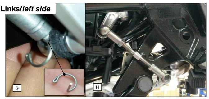
**G:** Entfernen Sie die Sicherungsspange am Kugelzapfengelenk des Schalthebels. **Verlieren Sie diese nicht!**
