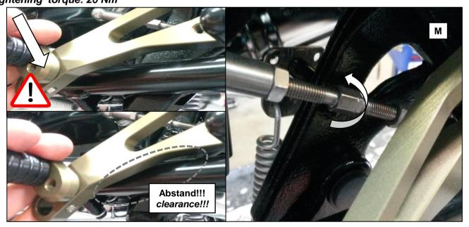
**M:** Testen Sie durch runterdrücken mit der Hand, ob der Schalthebel in der unteren Position genügend Freigängigkeit zum Seitenständer aufweist. **Der Schalthebel darf nicht aufsetzen!** Unter Umständen ist durch verdrehen der Schaltwelle die Hebelhöhe nach Oben zu korrigieren (Die hauptsächliche Höheneinstellung geschieht aber über die Trittstück- Exzenter).
