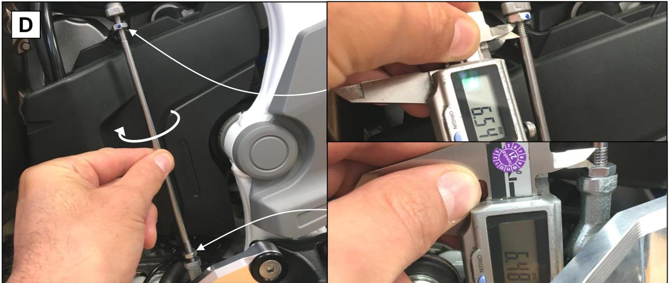
**D:** Drehen Sie die originale Schaltwelle gleichmäßig in die Kugelgelenkköpfe ein.
