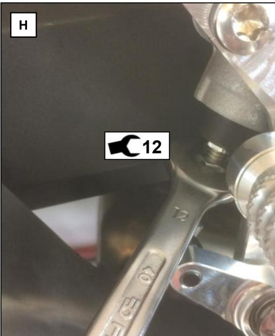
**H:** Kontern Sie die Einstellung des Adapters UAD03-23 wie im Bild dargestellt (Maulschlüssel 12)
