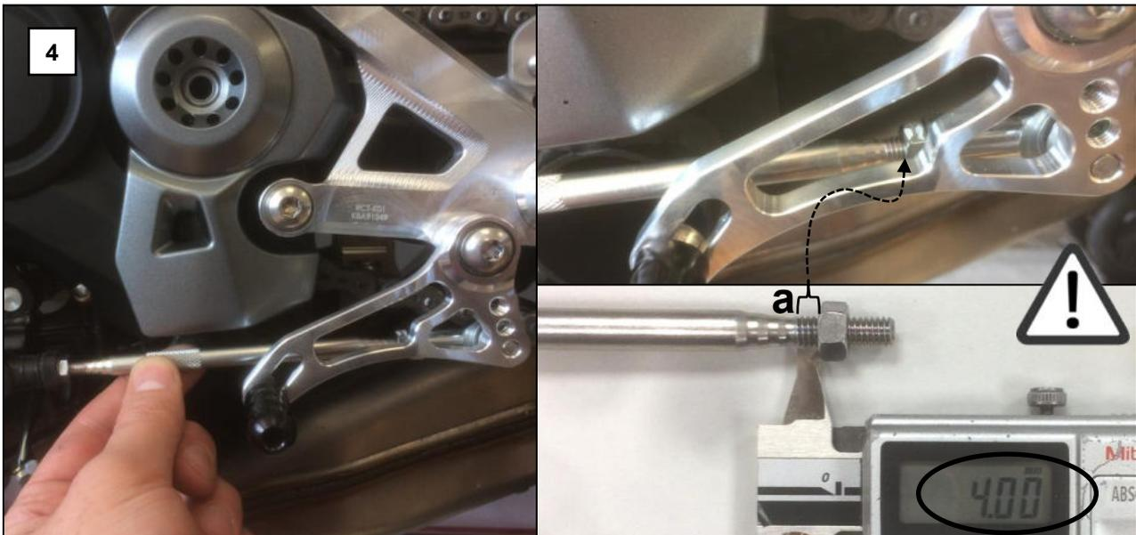
**4 Die Schalthebelhöhe gemäß Darstellung anpassen.** Drehen Sie die Schaltwelle um ergonomische Anpassungen bezüglich der Trittstückhöhe vorzunehmen.
