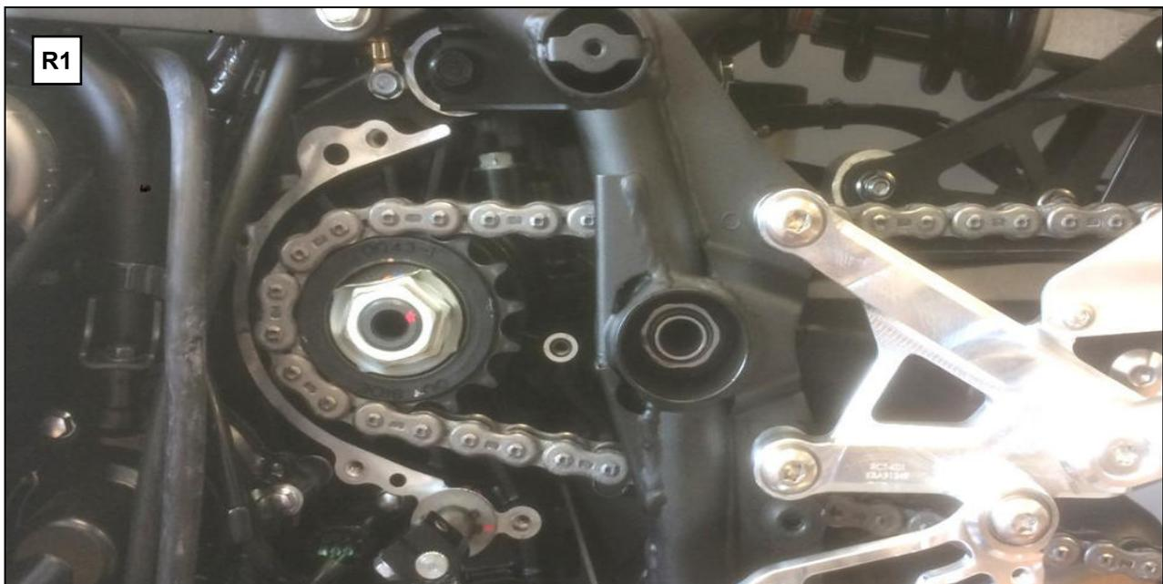
**R1:** Entfernen Sie die Ritzelabdeckung sowie die seitliche Rahmenverkleidung.
